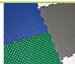
5. Для верной стыковки половиц следует уложить модули и, **надавливая пальцем**, состыковать угловые элементы замков половиц. Затем, ударами **резиновой киянки** состыковать остальные элементы, продвигаясь в направлении от угла половицы к её краям.
